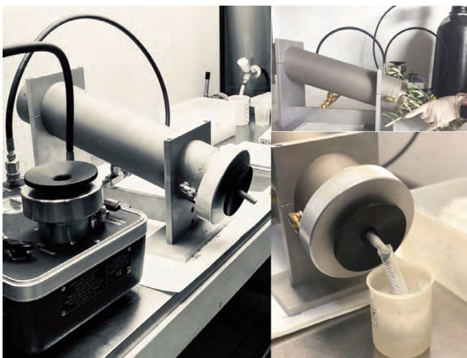
Extracción de savia de olivo mediante cámara de presión Scholander para el estudio del microbioma del xilema mediante aproximaciones de genómica y culturómica funcional
